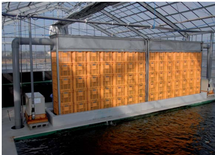
Obr. 8: skrápěný filtr s náplní média Crystal Bio
