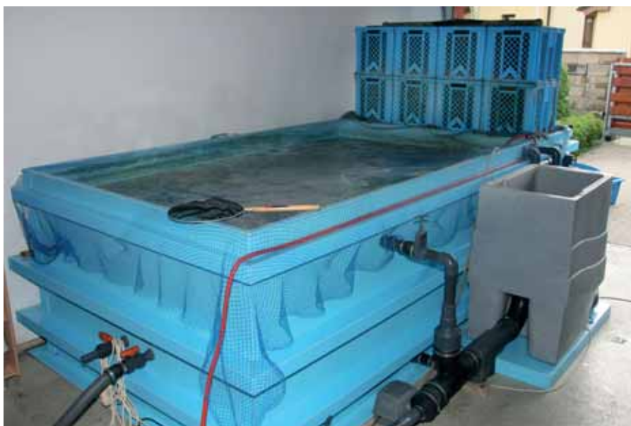
Obr. 2: plastové bazény s filtrací, vzadu skrácený biologický filtr, vpravo šterbinový mechanický filtr
